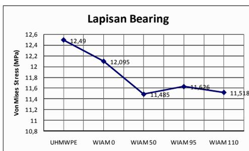
Gambar 8. *von Mises stress* pada bearing
