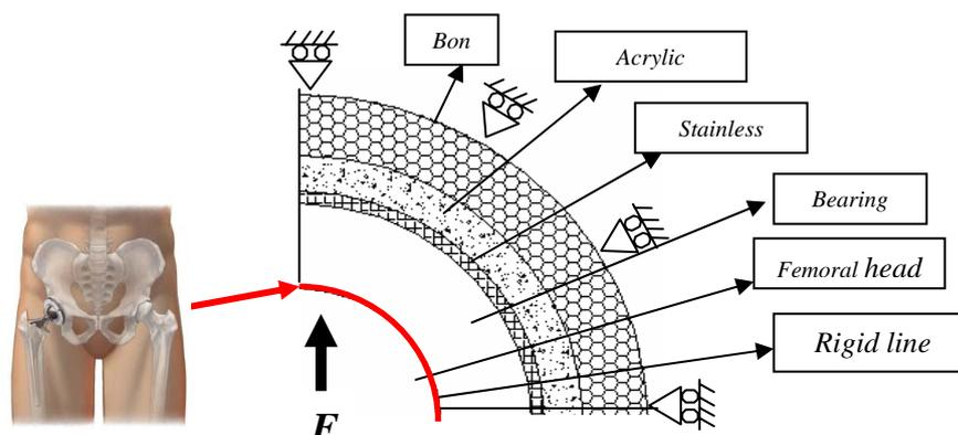
**Gambar 2.** Penyederhanaan model kontak (Sutrisno I., 2009)
