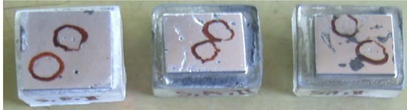
Gambar 6. Sampel coran penuangan dengan cawan *offset basin*
