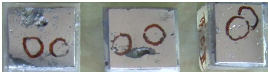
Gambar 5. Sampel coran penuangan langsung/tanpa cawan
