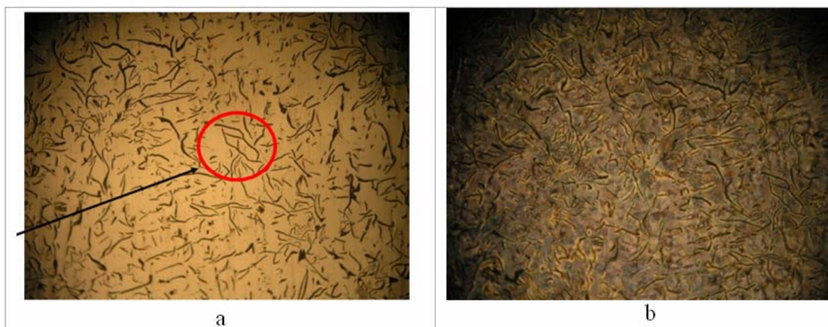
Gambar 3. Struktur mikro pada daerah 1 (a) tanpa etsa, (b) etsa nital 2,5 % (perbesaran 100 x)
