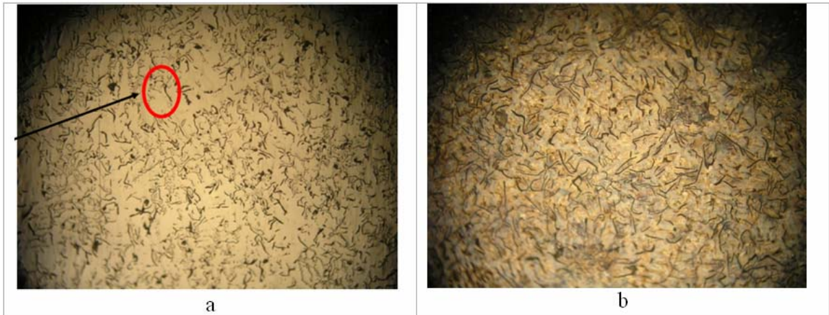
Gambar 4. Struktur mikro pada daerah 2 (a) tanpa etsa, (b) etsa nital 2,5 % (perbesaran 100 x)
