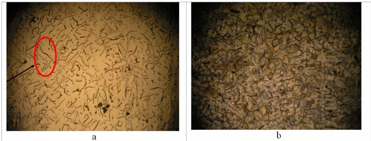
Gambar 5. Struktur mikro pada daerah 2 (a) tanpa etsa, (b) etsa nital 2,5 % (perbesaran 100 x)
