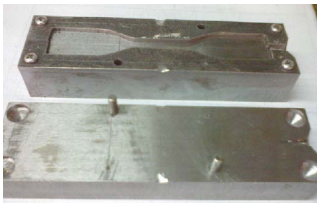
Gambar 2. Cetakan sampel uji tarik plastik
