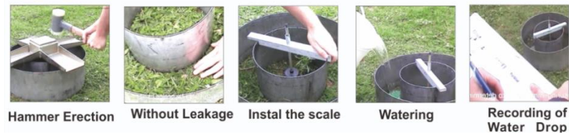
Gambar 1 B : Pemasangan “Double Ring Infiltrometer”
