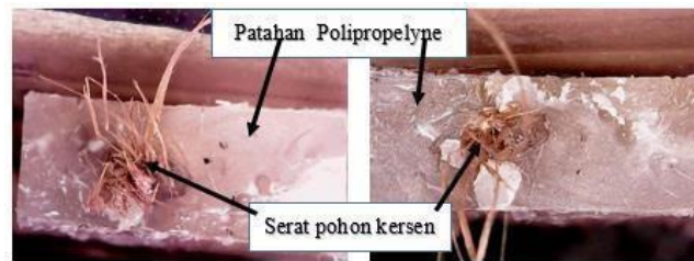
Gambar 9. Foto makro komposit serat pohon kersen dengan fraksi volume 6%
