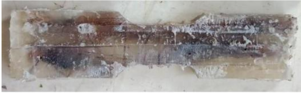
Gambar 5. Specimen komposit serat kersen dengan matriks PP
