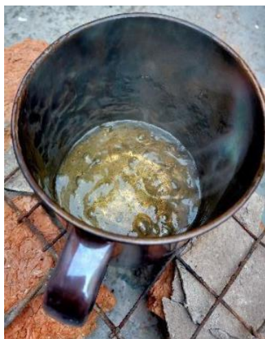
Gambar 4. Pencairan biji polipropilena
