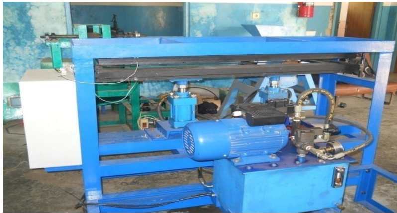
Gambar 7 : Mesin press otomatis dengan sistim pneumatik berbasis PLC
