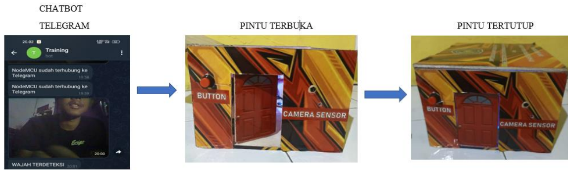
Gambar 3. Pengujian kamera ESP32 CAM pada alat
