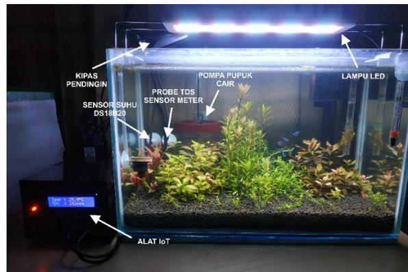
**Gambar 7. Posisi Penempatan Alat**
