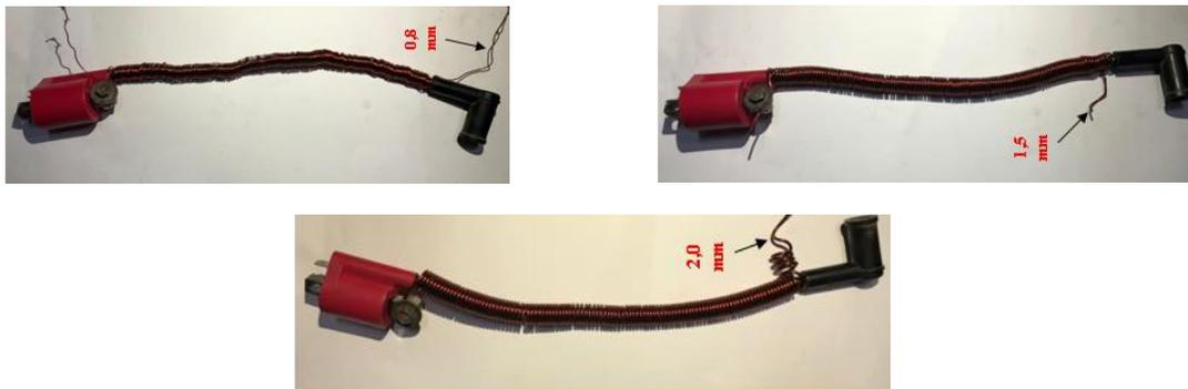
Gambar 1. Kawat *ground strap* pada kabel koil
