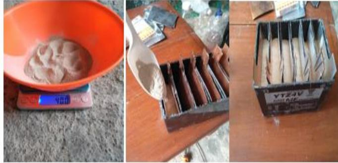
**Gambar 3. Pengukuran berat zeolit dan penuangan serbuk zeolit ke aki baterai**
