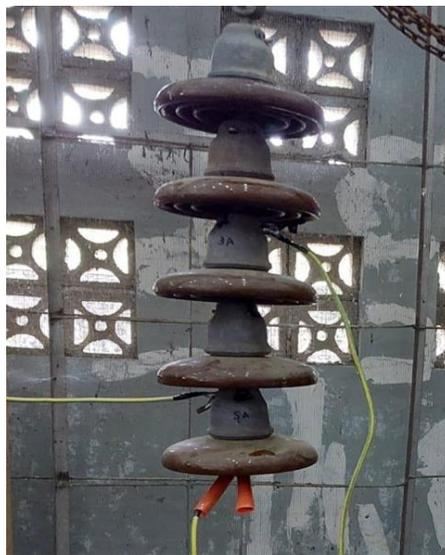
Gambar 3. Pengujian tegangan tembus isolator berlumut
