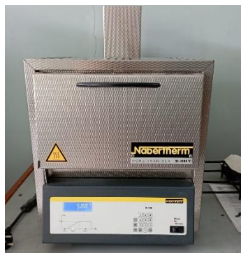
Gambar 2. Tungku perlakuan panas dan tempering
