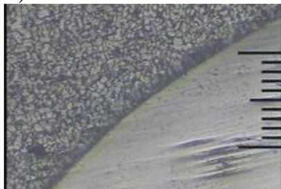
Gambar 3. Batas antara weld metal dengan HAZ baja karbon dengan PWHT 400oC perbesaran 200 x
