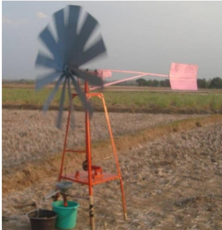
**Gambar 2. Prototipe Pompa Air Tenaga Angin**
