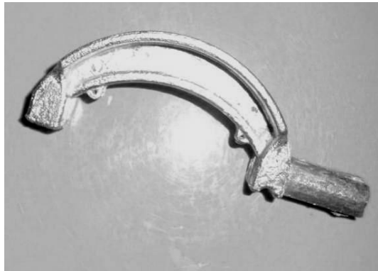
Gambar 4. Hasil pengecoran squeeze temperatur tuang 700^{\circ}\text{C} temperatur cetakan 400^{\circ}\text{C} tekanan 125,71\text{ MPa}
