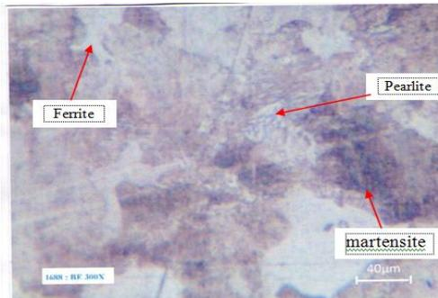
**Gambar 6.** Strukturmikro Baja Karbon Dengan Penahanan Selama 30 Menit (300x)
