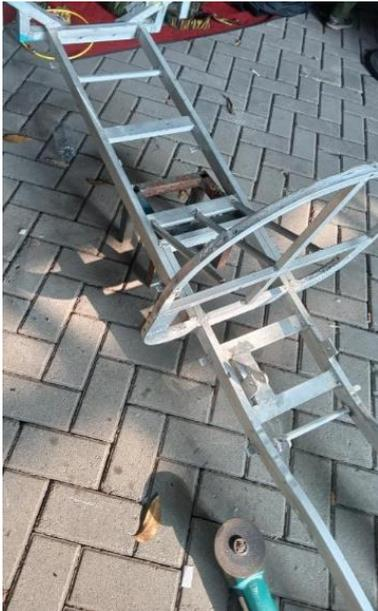
Gambar 2.4 Bentuk hasil manufacture chassis
