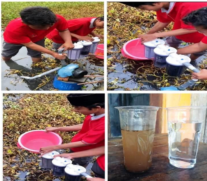
Gambar 5. Uji Coba Penyaringan Air dengan Alat Filtrasi PWC-FG
