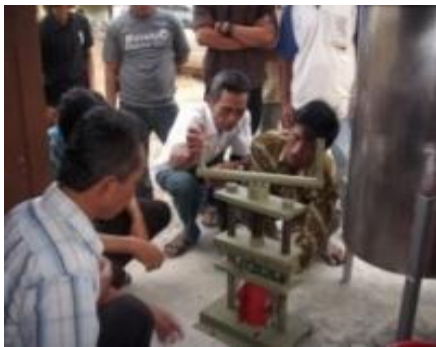
Gambar 6. Pencetakan Briket pada mitra Bapak Achmad Munzaeni
